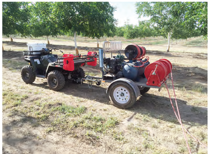
Controlador de Roedores de Escape Presurizado. Foto: Cortesía : www.perryswildlifecontrol.com
