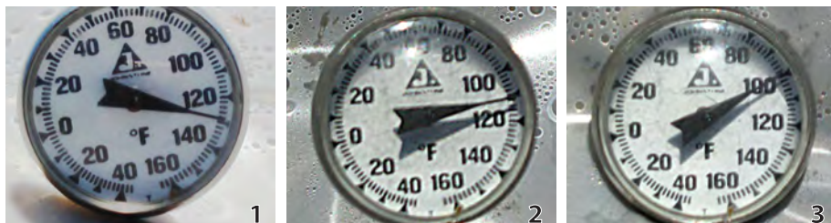
Temperatura en la superficie (1), temperatura a 3 pulgadas de profundidad (2), y temperatura a 6 pulgadas de profundidad (3). Fotos: Martin Guarena, NCAT
